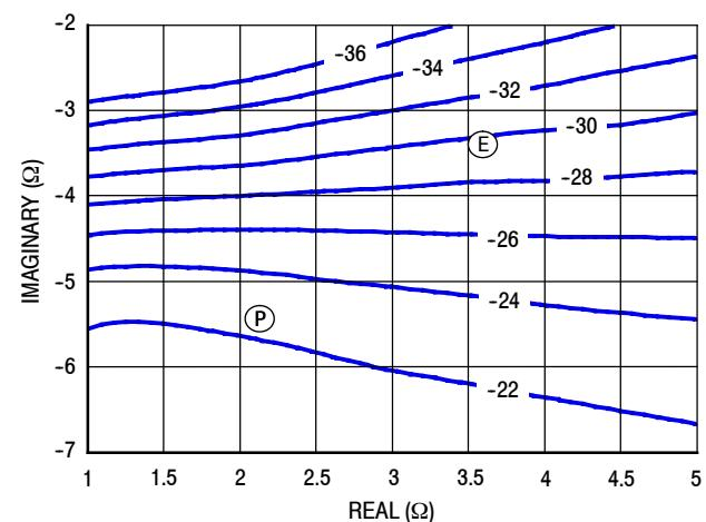
Figure 25. P1dB Load Pull AM/PM Contours (°)
