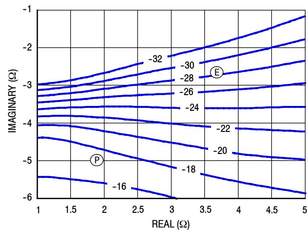
Figure 21. P3dB Load Pull AM/PM Contours (°)
