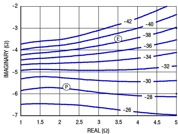
Figure 29. P3dB Load Pull AM/PM Contours (°)
