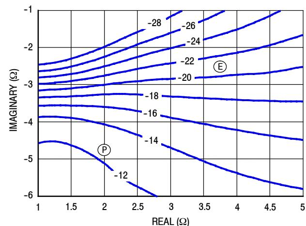
Figure 17. P1dB Load Pull AM/PM Contours (°)
