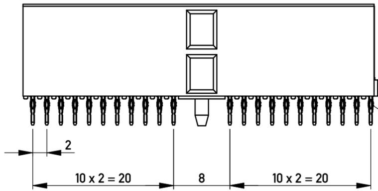
EN Zone für durchkontaktierte Löcher  $\phi 0,6 \pm 0,05$
