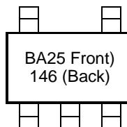
5-Lead SOT-23 (MCP6541, MCP6541R, MCP6541U)
