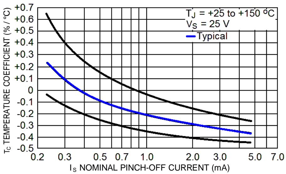
**FIGURE 2 – TEMPERATURE COEFFICIENT**
