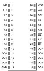
28-PIN ENCAPSULATED PACKAGE (700 MIL EXTENDED)
