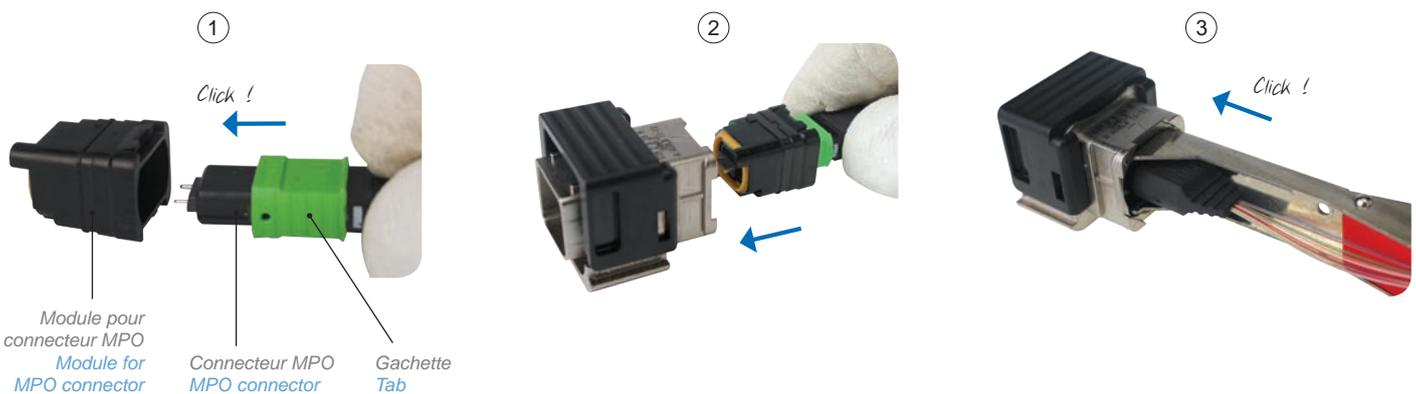
① Présenter le connecteur MPO face au module et le pousser à l'intérieur jusqu'au clic de verrouillage
