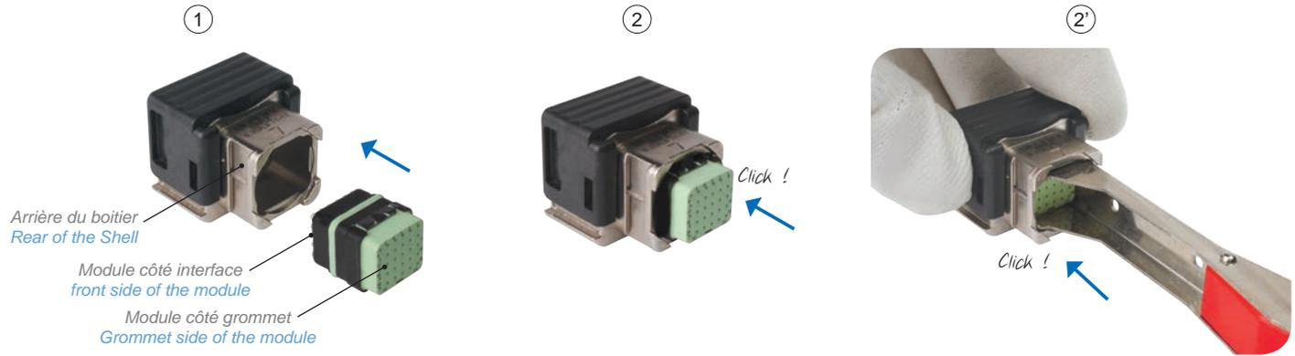
① Présenter le module côté interface à l'arrière du boîtier du connecteur, en face de la cavité présentant le bon détrompage (le module standard N pouvant être utilisé dans toutes les cavités)
