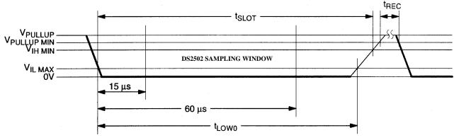
60  $\mu s \le t_{LOW0} < t_{SLOT} < 120 \ \mu s$ 1  $\mu s \le t_{REC} < \infty$
