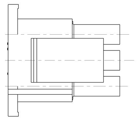
1. SMALL NICKS ARE PERMITTED ON THE CIRCUIT TOWERS WHICH COULD INCREASE THE INITIAL HOUSING MATING FORCE UP TO 4.4 NEWTONS (10 LBS). NO INDIVIDUAL NICKED TOWER SHALL INCREASE THIS FORCE BY OVER 2.2 NEWTONS (.5 LBS)
