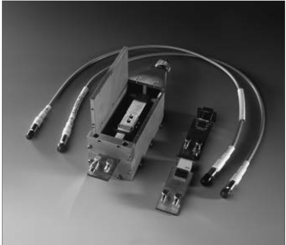
Fig. 7 : Triaxial test cel
